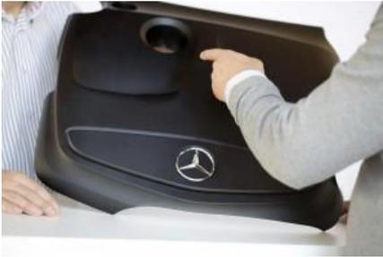
Le capot pèse seulement 1,320 kg contribue à l'allègement de la classe A et donc à la diminution de l'utilisation de carburant, moins 26% par rapport à la génération précédente. Mercedes-Benz ajoute que ce capot moteur induit 60% de moins d'émissions de CO<sub>2</sub> que sa version pétrosourcée. « *La différence par composant est d'environ 6,5 kg de dioxyde de carbone* », explique le rapport.
